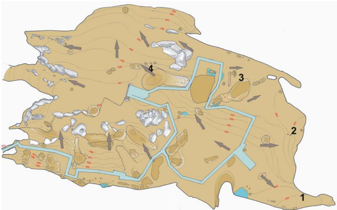
Fig. 39. Distribución del CO 2 en la cavidad con la entrada de grupos numerosos de personas durante el periodo 2005 – 2006. Aunque se distribuye más por toda la cavidad mantiene la tendencia de migrar hacia la zona sur de la cavidad, donde fueron selladas las grietas desde el exterior.
