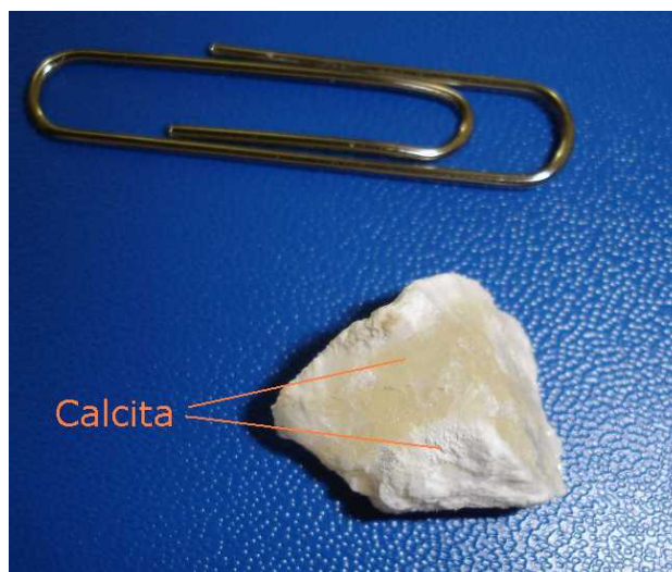
Figura 9: Distinto aspecto superficial, mismo tipo de cristalización en muestra 6.
