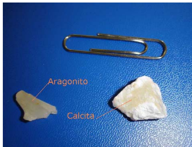
Figura 11: Mismo aspecto superficial, distinto tipo de cristalización en muestras 1 y 6.
