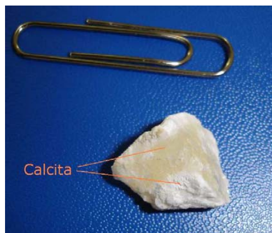
Figura 4. Distinto aspecto superficial en una muestra de zona 3 donde se observa el aspecto pulverulento de las zonas afectadas por decarbonatación.
